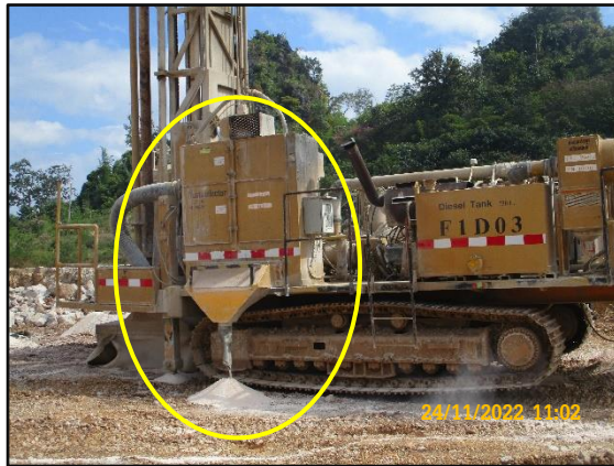
ภาพที่ 2.11 อุปกรณ์เก็บฝุ่น (Dust Collector)
